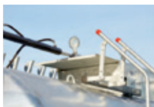
Pumpás tartálykocsinál: hidraulikus toltető
