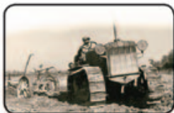
Multi Fuel Boghetto 40: A híres Fiat modell, amely többféle üzemanyaggal – fűtőolaj, benzin, dízel, növényi- és állati olaj – is üzemeltethető volt.
