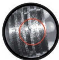
A SZIVATTYÚ DUGATTYÚINAK KÁROSODÁSA
