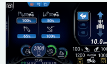
Elektronikus 3. pont vezérlés
