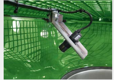
✓ Üresjelzés-érzékelő a ZA-TS műtrágyaszóróban
