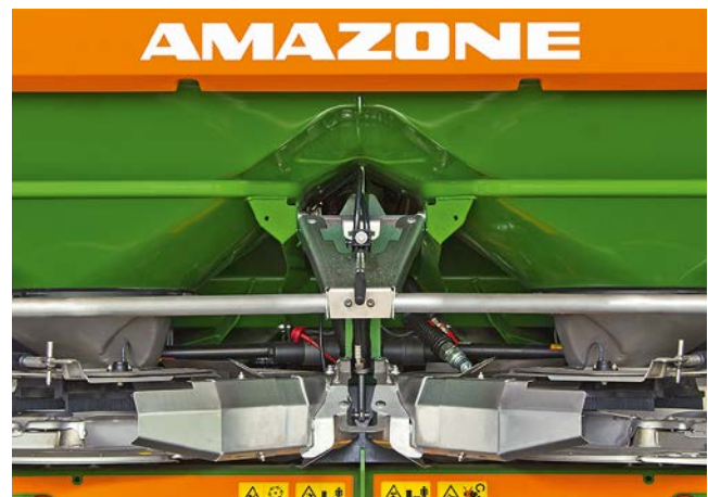
Mindkét oldalon befordított ágyásszóró ernyő teleszkópos végelemekkel
