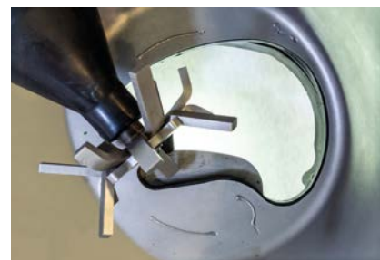
3. fokozat: Tölcsérnyílás szélesen nyitott
