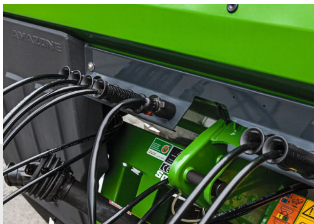
Könnyen áttekinthető csatlakozósor a hidraulikus tömlőkhöz
