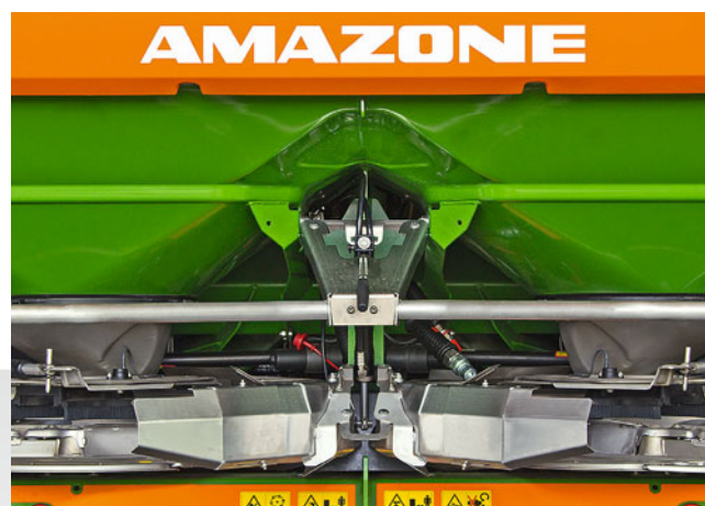
Mindkét oldalon befördített ágyásszóró ernyő teleszkópos végelemekkel
