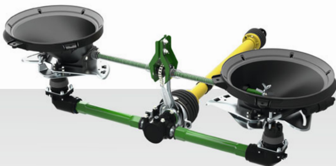
A mechanikus meghajtású ZA-V sematikus ábrája
