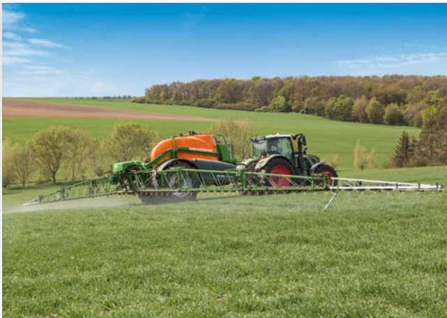
ContourControl a szórókeret lefelé irányuló oldalszög-beállításával
