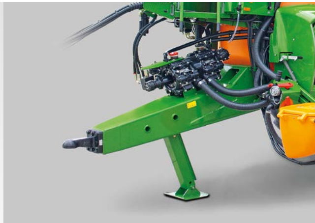
Merev Hitch vonórúd, hidraulikus szivattyúhajtással
