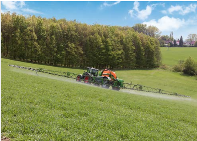
ContourControl a szórókeret felfelé irányuló oldalszög-beállításával
