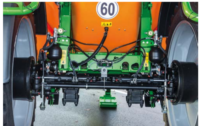
Hidropneumatikus tengelyrugózás és AutoTrail hídvezérlés
