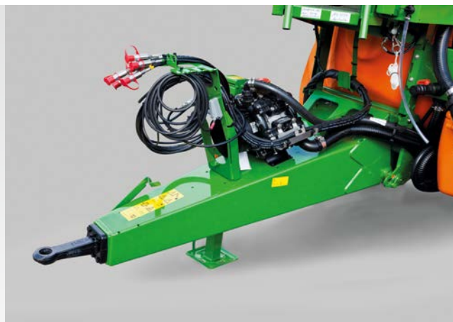
Alsó bekötés vonószemmel és mechanikus támasztólábbal
