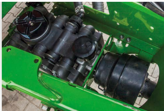
Az UX Special felszerelhető 260 l/perc és 380 l/perc teljesítményű szivattyúval.
