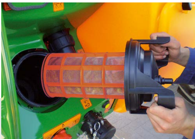
A szívósűrő akkor is kinyitható és megtisztítható permetlé veszteség nélkül, ha a tartály tele van.
