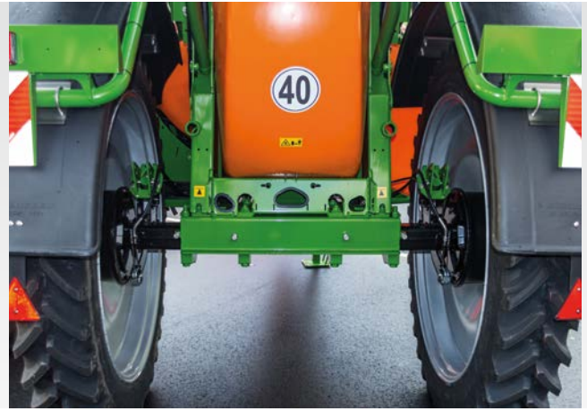
1,50 m és 2,25 m között fokozatmentesen állítható nyomtávú híd
